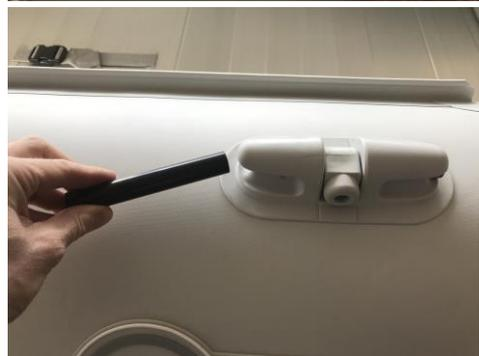
Vermitteln Sie das Röhrchen im Ruderhalter und Bohren mit einem 2,5 mm Bohrer ein Loch ins Röhrchen
